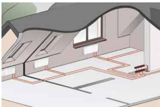
Fűtési hálózat T-csatlakozós és osztó-gyűjtő rendszere
